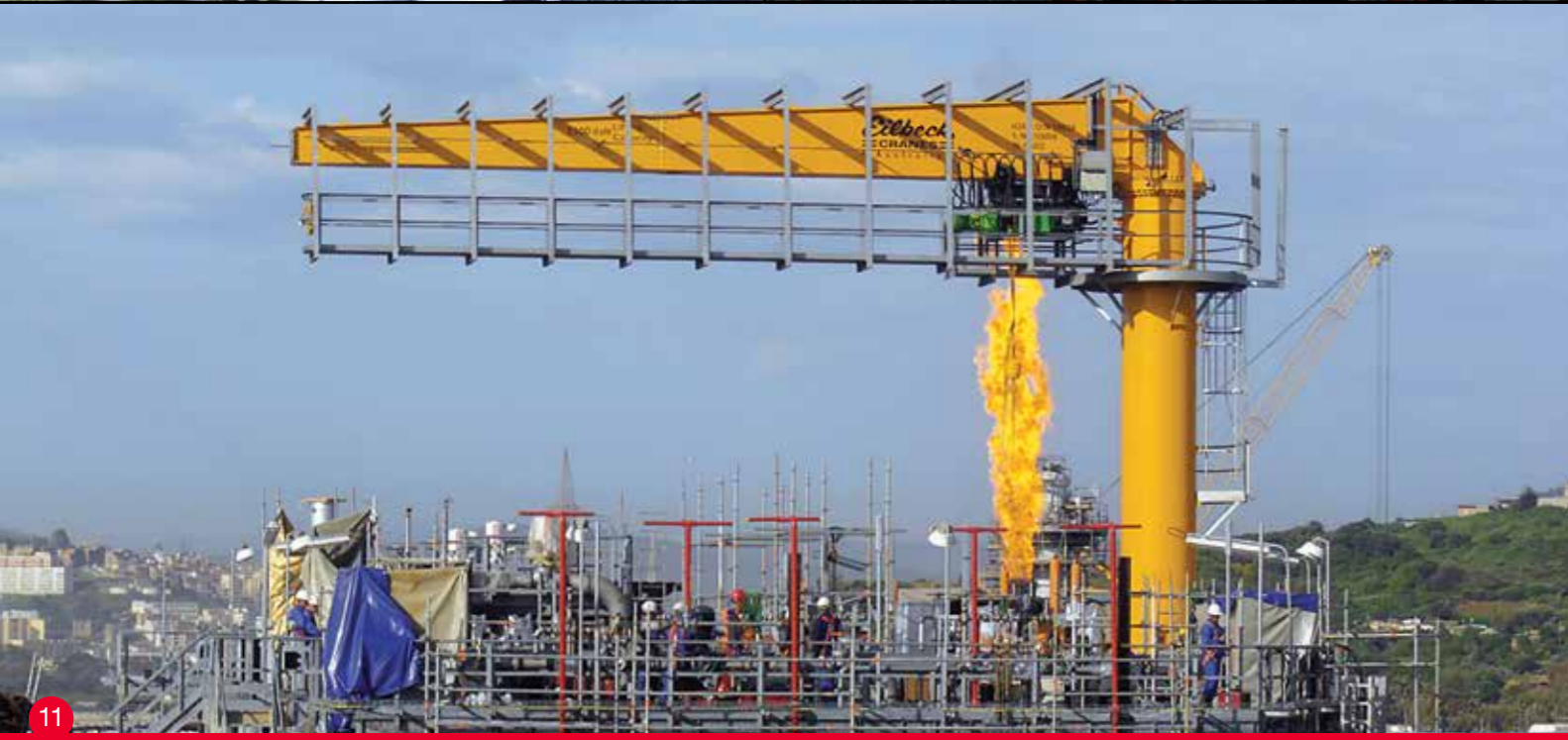
Tank Jib Cranes servicing LNG pumps Bonny Island, Nigeria
