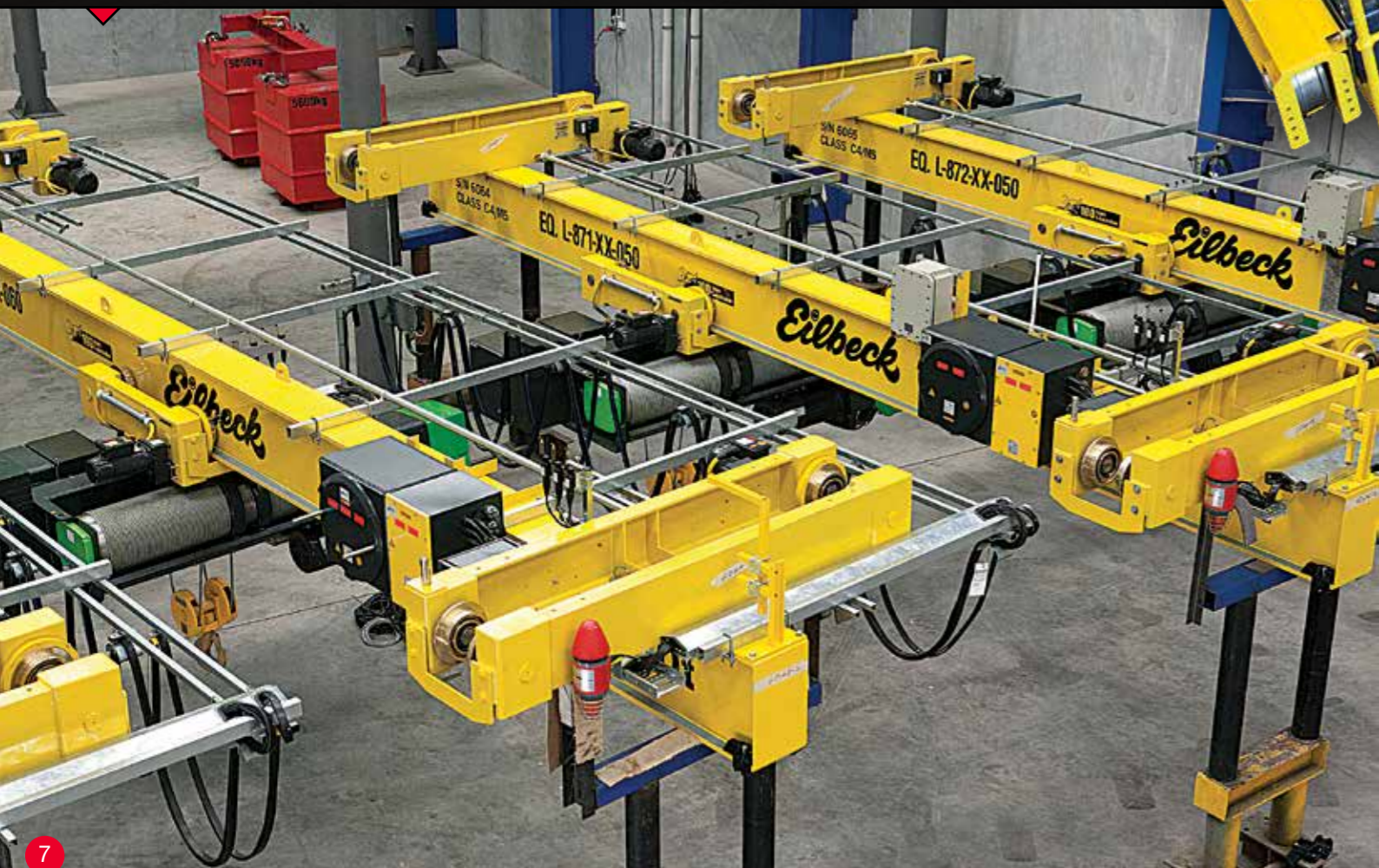
In-house load testing of 10t EDL LNG Onshore Crane, LNG Modules transported to Thailand
