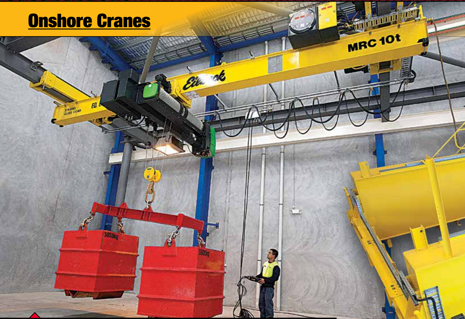
In-house load testing of 10t EDL LNG Onshore Crane, LNG Modules transported to Thailand
